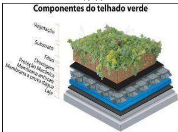
Figura 88. Esquema construtivo de telhado verde
