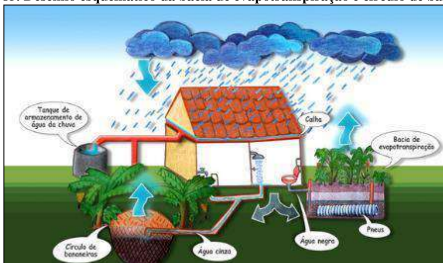
Figura 85. Desenho esquemático da bacia de evapotranspiração e círculo de bananeiras
