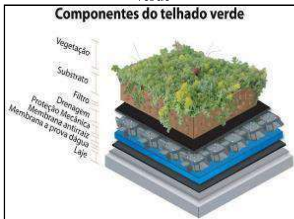
Figura 88. Esquema construtivo de telhado verde
